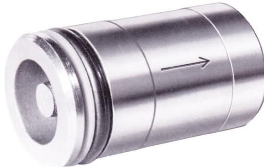
Patronen-Rückschlagventile zum **Direkteinbau in Geräte- und Maschinengehäuse** geben den Durchflußstrom in einer Richtung frei und sperren ihn in der Gegenrichtung. Sie gehören deshalb zur Gruppe der Sperrventile (DIN 24300).
