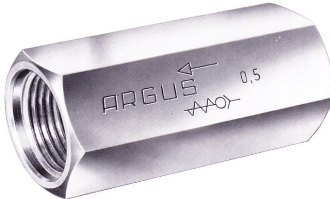
Rückschlagventile geben den Durchflußstrom in einer Richtung frei und sperren ihn in der Gegenrichtung. Sie gehören deshalb zur Gruppe der Sperrventile (DIN 24300).
