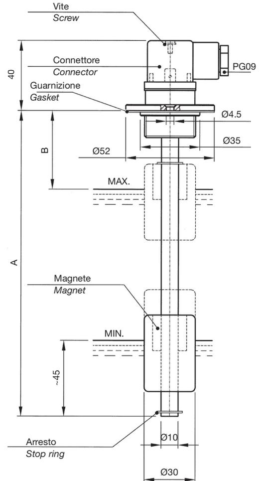
**MATERIALI:** flangia in alluminio anodizzato, tubo in ottone, anelli di arresto in bronzo, galleggiante in resina espansa NBR.
