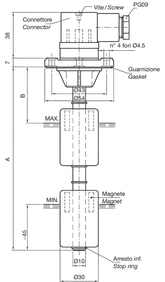
**MATERIALI:** flangia in termoplastico, tubo in ottone, molla e anelli di arresto in bronzo, galleggiante in resina espansa NBR.
