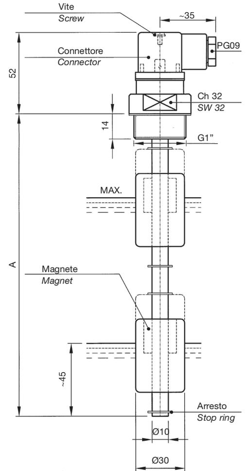
**MATERIALI:** flangia filettata in alluminio anodizzato, tubo in ottone, molla e anelli di arresto in bronzo, galleggiante in resina espansa NBR.
