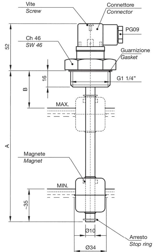
MATERIALE: flangia filettata G 1 1/4", tubo, anelli di arresto e galleggiante in acciaio inox.
