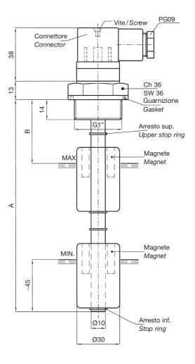
MATERIALI: flangia filettata in termoplastico, tubo in ottone, molla e anelli di arresto in bronzo, galleggiante in resina espansa NBR.
