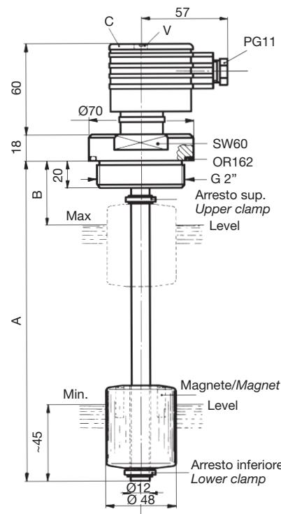
Le sonde di livello SL1FA...CVS1, SL2FA...CVS1 e SL1TA...CVS1 SL2TA...CVS1 con convertitore di segnale 4/20 mA alloggiato nel connettore C, sono state concepite per controllare in continuo il livello di un liquido contenuto in un serbatoio di stoccaggio.
