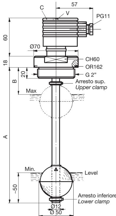
Le sonde di livello SL1FIA...CVS1, SL2FIA...CVS1 e SL1TIA...CVS1, SL2TIA...CVS1 con convertitore di segnale 4/20 mA alloggiato nel connettore C, sono state concepite per controllare in continuo il livello di un liquido contenuto in un serbatoio di stoccaggio.
