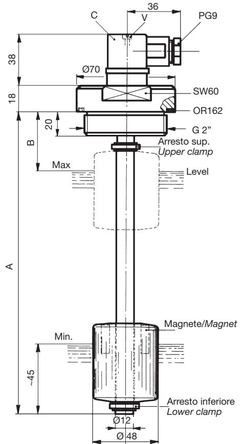
Le sonde di livello SL1FA..., SL2FA... e SL1TA..., SL2TA... sono state concepite per controllare a distanza in continuo il livello di un liquido contenuto in un serbatoio di stoccaggio, mediante i nostri indicatori digitali.
