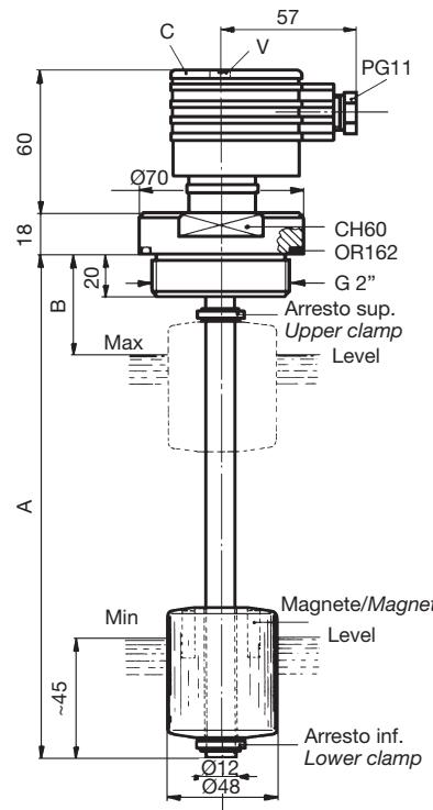
Le sonde di livello SL1F3A..., SL2F3A... e SL1T3A..., SL2T3A... sono state concepite per controllare il livello di un liquido contenuto in un serbatoio e inviare a distanza tre segnali di allarme regolabili a piacere. Installate sopra un serbatoio contenente il fluido da controllare, trasmettono per mezzo del trasduttore lineare posto all'interno del tubo lungo il quale scorre il galleggiante con magnete, un segnale variabile, in funzione della posizione assunta dal livello del liquido.
