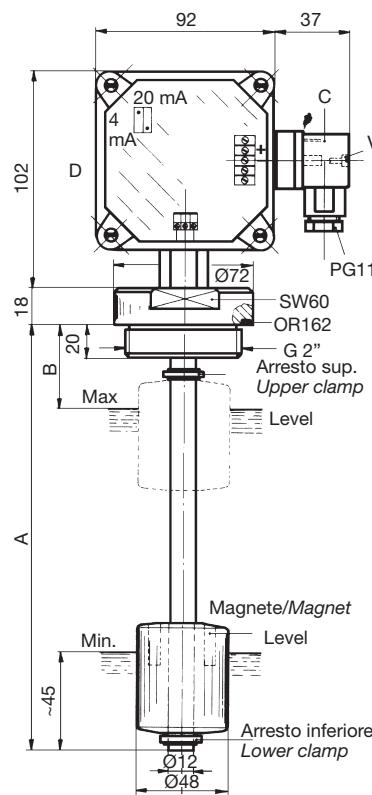
Le sonde di livello SL1FA...CVS2, SL2FA...CVS2 e SL1TA...CVS2, SL2TA...CVS2 con convertitore di segnale 4/20 mA alloggiato nella custodia D, sono state concepite per controllare in continuo il livello di un liquido contenuto in un serbatoio di stoccaggio.
