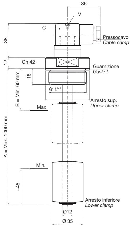
Le sonde di livello SLM1FA..., SLM2FA... e SLM1TA..., SLM2TA... sono state concepite per controllare a distanza in continuo il livello di un liquido contenuto in un serbatoio di stoccaggio, mediante i nostri indicatori digitali.
