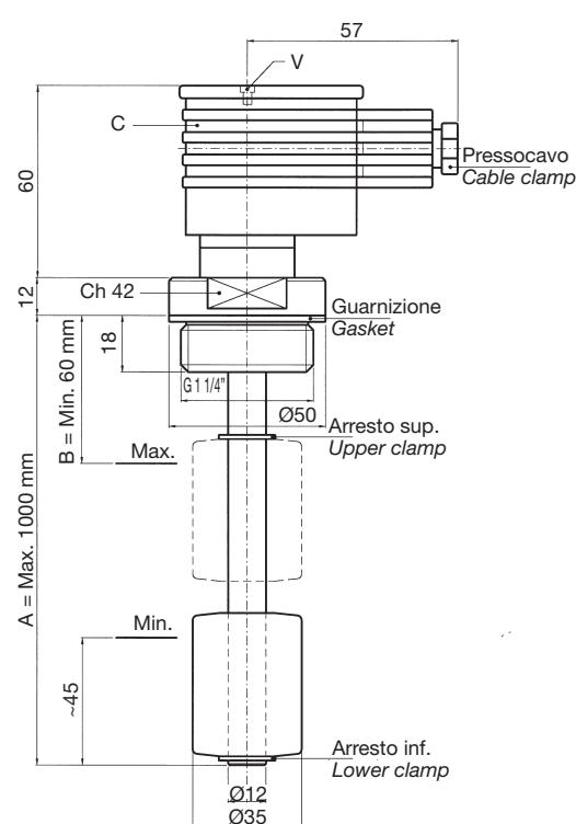
Le sonde di livello SL1M3FA..., SL2M3FA... e SL1M3TA..., SL2M3TA... sono state concepite per controllare il livello di un liquido contenuto in un serbatoio e inviare a distanza tre segnali di allarme regolabili a piacere.
