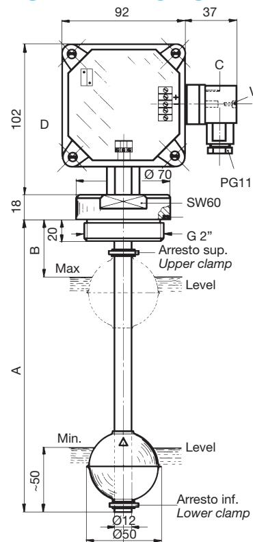
Le sonde di livello SL1FIA...CVS2, SL2FIA...CVS2 e SL1TIA...CVS2, SL2TIA...CVS2 con convertitore di segnale 4/20 mA alloggiato nella custodia D, sono state concepite per controllare in continuo il livello di un liquido contenuto in un serbatoio di stoccaggio.
