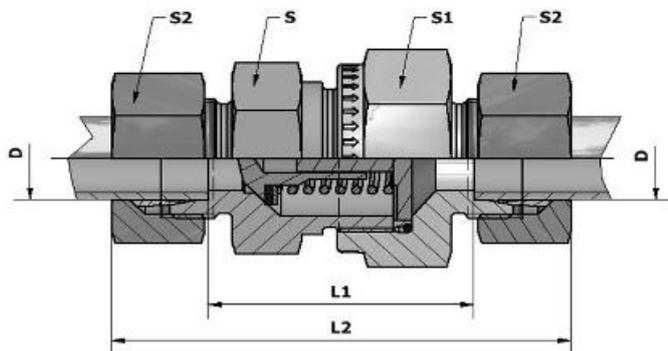
Öffnungsdruck serienmäßig 1 bar / cracking pressure standard 1 bar
