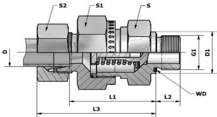
Öffnungsdruck serienmäßig 1 bar / cracking pressure standard 1 bar
